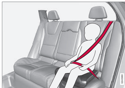
Position assise correcte : la tête de l'enfant ne dépasse pas l'appui-tête et le boudrier est placé en travers de la clavicule
