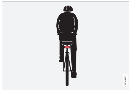
Ejemplo óptimo de lo que el sistema interpreta como un ciclista, con un perfil de cuerpo y bicicleta bien definido, visto por detrás y desde el centro del automóvil.
