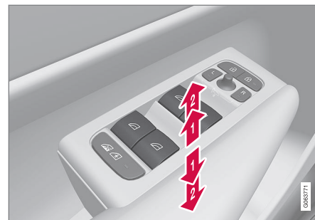
Bedieningsknoppen elektrisch bedienbare ruiten.
