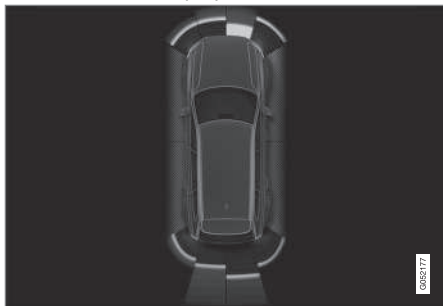
Beeldscherm met obstakelzones en sensorsegmenten.
