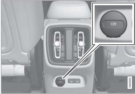
منفذ USB (النوع C) في الجهة الخلفية من كونسول النفق لشحن الهواتف والأجهزة اللوحية على سبيل المثال.
