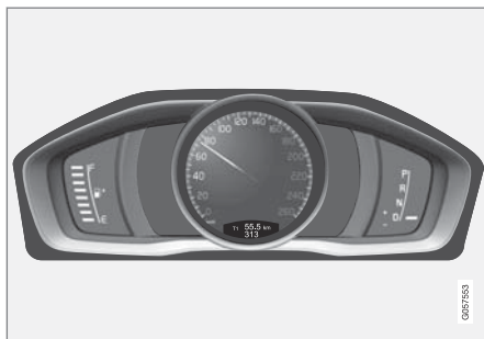
綜合儀錶板的資訊顯示器 28 中可顯示旅程電腦所提供的資訊。
