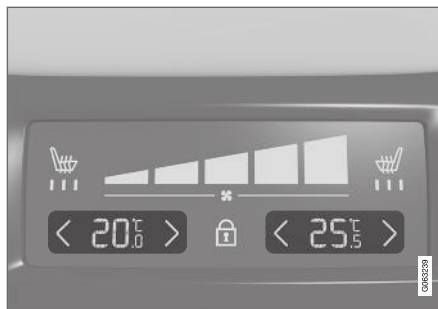
Tunnelkonsooli tagaosa kliimapaneeil olev temperatuuri regulaator.
