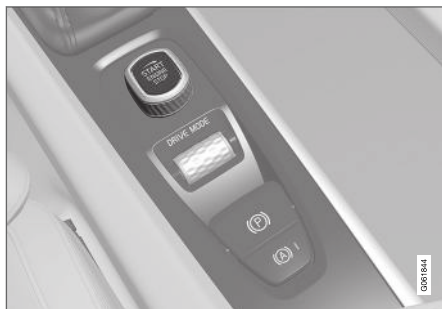
Tunnelkonsoolil paiknev käivitusnupp.
