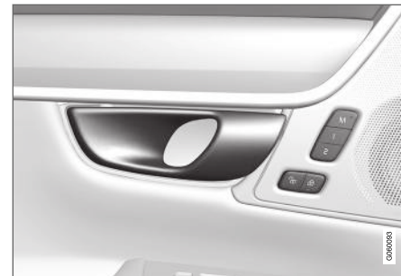
Åpningshåndtak for alternativ opplåsing av sidedør 12 .
