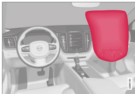
Kollisjonspute på passasjersiden i forsetet.
