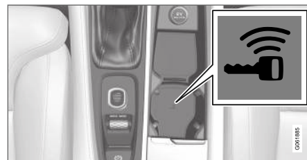
Reserveleserens plassering i tunnelkonsollen.
