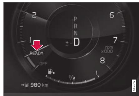
Funksjonen er aktiv og motoren har stanset automatisk.
