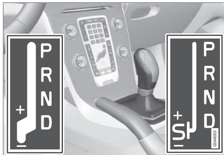
D: Cambios de marcha automáticos. +/-: Cambios de marcha manuales. S: Modo Sport*. 12
