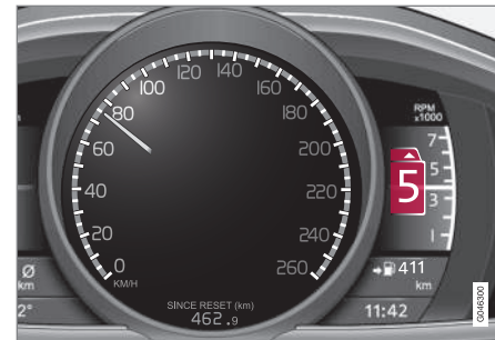
Cuadro de instrumentos "Digital" con indicador de cambio de marcha.
