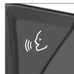
Appuyer sur le bouton du clavier placé à droite du volant de direction pour activer le système et lancer un dialogue de commande vocale.
