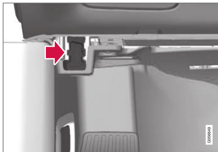
Andmeühenduse konnektor (On-board Diagnostic, OBDII) asub juhipoolsel küljel armatuurlaua all.
