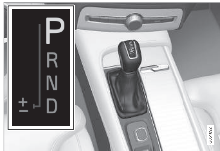
Vue d'ensemble du grand levier de vitesses et de la grille de rapports dans l'écran du conducteur.
