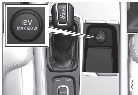
Prise 12 V dans la console de tunnel, de siège avant.
