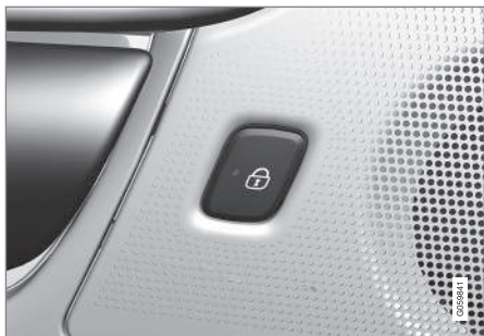
Boutons de verrouillage avec lampe indicatrice dans la porte arrière.
