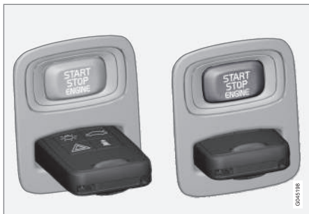
Zündschloss mit herausgezogenem/ingedrücktem Transponderschlüssel.
