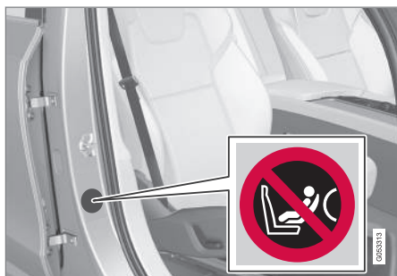
Naklejka na słupku drzwiowym po stronie pasażera. Naklejka poduszki powietrznej jest widoczna po otwarciu drzwi pasażera.
