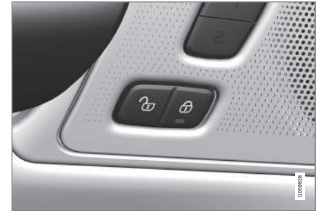
Boutons de verrouillage/déverrouillage centralisé et témoins lumineux sur les portes avant
