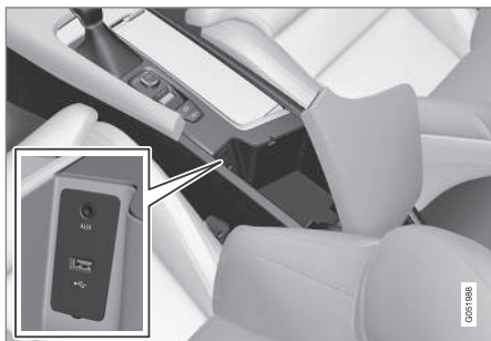
Prise USB dans la console de tunnel.
