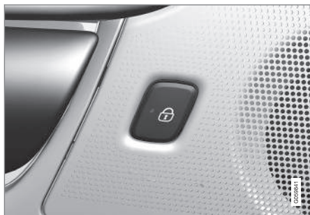
Bouton de verrouillage et témoin lumineux dans une porte arrière.
