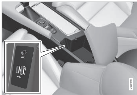
Prises AUX et USB de la console de tunnel
