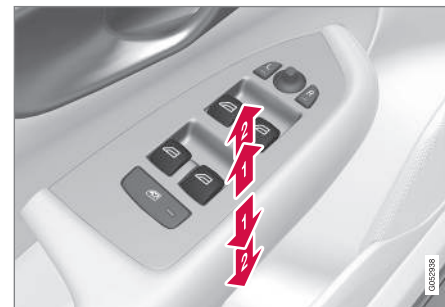
Fonctionnement des vitres électriques
