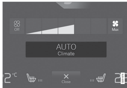
Touche de climatisation Auto dans la vue Climatisation
