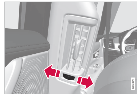
Molette de bouche de ventilation 7 .
