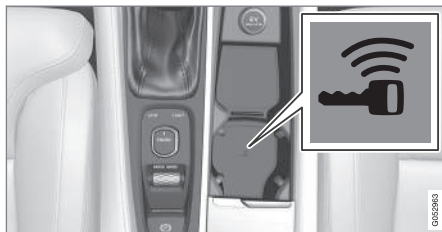
Lecteur de clé de sauvegarde dans la console de tunnel
