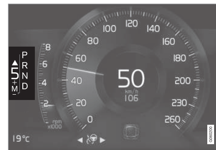
A fokozatváltás visszajelzése 8-hüvelykes járművezetői kijelzőn, nagy sebességváltó karral.
