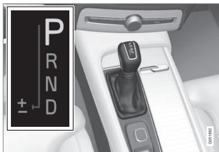
A nagy sebességváltó kar és a váltási minta áttekintése a járművezetői kijelzőn.
