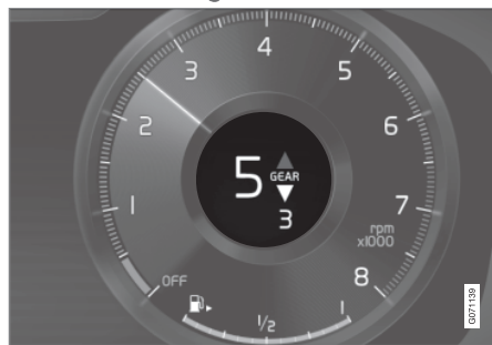
Fokozatváltás-jelző a 12-hüvelykes járművezetői kijelzőn*.
