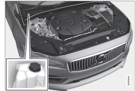
Hűtőfolyadék táglási tartálya, jobbkormányos autó.
