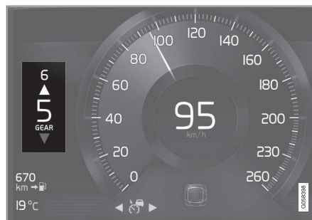
Fokozatváltás-jelző a 8-hüvelykes járművezetői kijelzőn.
