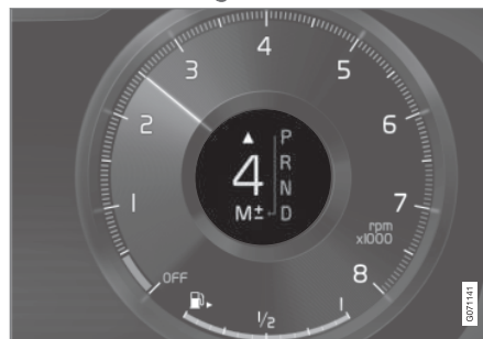
A fokozatváltás visszajelzése 12-hüvelykes járművezetői kijelzőn, nagy sebességváltó karral*.
