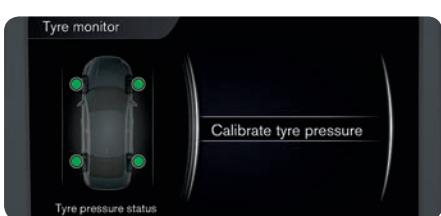
**Como efectuo a calibragem do sistema de monitorização da pressão dos pneus (TM)\*?** 01
