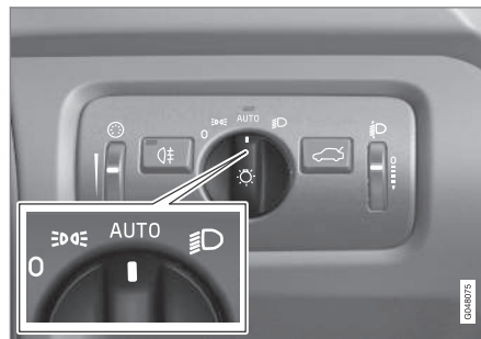
Bouton du commutateur d'éclairage en position AUTO .
