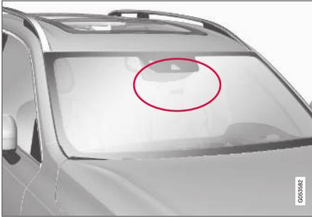
La zone indiquée ne doit pas être couverte (ni autocollant, ni filtre solaire, ni aucun autre objet, etc.)<sup>73</sup>.
