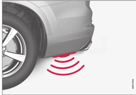
Pour activer l'ouverture ou la fermeture à l'aide du pied sur les voitures avec plaque de protection, le mouvement doit être effectué depuis le côté de la voiture. L'une des télécommandes de la voiture doit se trouver dans la zone de couverture (env. 1 mètre/3 pieds) pour permettre l'ouverture et la fermeture.
