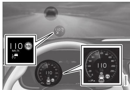
L'illustration précédente<sup>64</sup> indique que le régulateur adaptatif de vitesse est réglé pour maintenir une vitesse de 110 km/h (68 mph) et qu'il suit un véhicule qui roule à la même vitesse.
