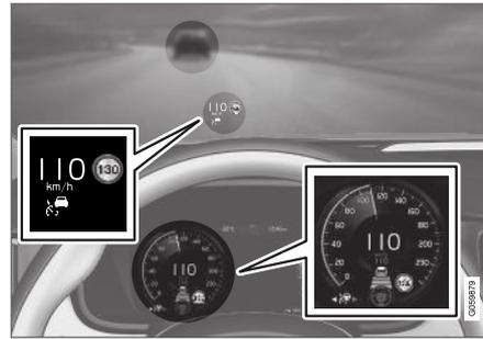
L'illustration précédente<sup>72</sup> indique que Pilot Assist est réglé pour maintenir une vitesse de 110 km/h (68 mph) et qu'il suit un véhicule qui roule à la même vitesse.
