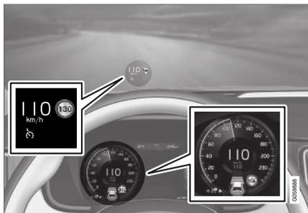
L'illustration précédente<sup>64</sup> indique que le régulateur adaptatif de vitesse est réglé pour maintenir une vitesse de 110 km/h (68 mph) et qu'il n'y a aucun véhicule à suivre.
