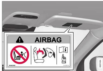
Autocollant sur le pare-soleil du côté passager.
