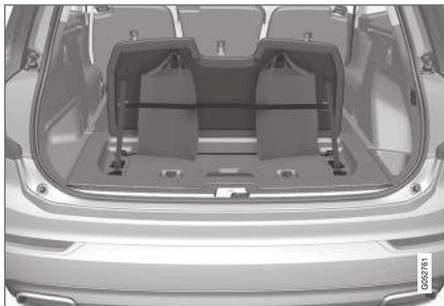
Deux crochets pour sacs à provisions et une sangle élastique<sup>4</sup> sont fixés sur le couvercle (partie de la trappe de plancher) dans le compartiment à bagages. La sangle peut être installée selon quatre positions différentes.
