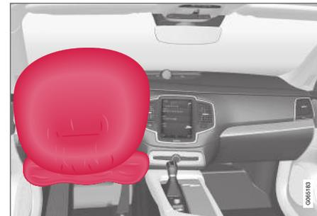
Coussin gonflable dans le volant et coussin gonflable de genoux du siège avant, côté conducteur.
