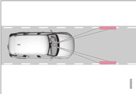
Une caméra détecte le marquage au sol sur la chaussée et compare son tracé aux mouvements du volant.
