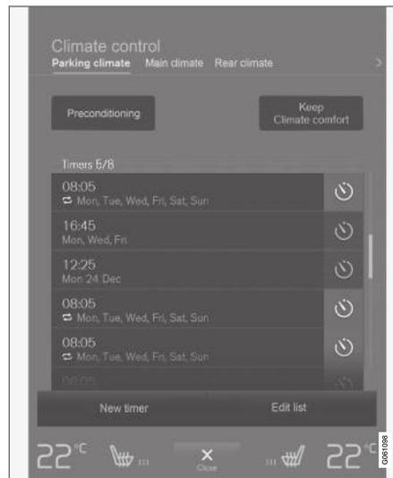
Le préconditionnement et le maintien du confort climatique sont commandés depuis l'onglet **Climatisation à l'arrêt** de la vue Climatisation de l'écran central.
