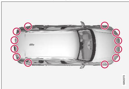
Emplacement des capteurs de stationnement<sup>118</sup>.
