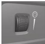
La molette du tableau de bord, près du volant, permet de régler l'intensité lumineuse de l'écran, l'éclairage des commandes et l'éclairage d'ambiance\*
