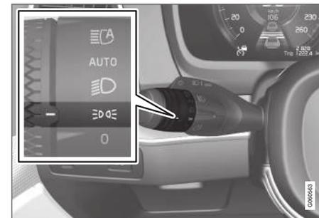
Molette du levier au volant en position de feux de position.
