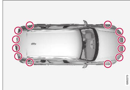
Emplacement des capteurs de stationnement<sup>132</sup>.
