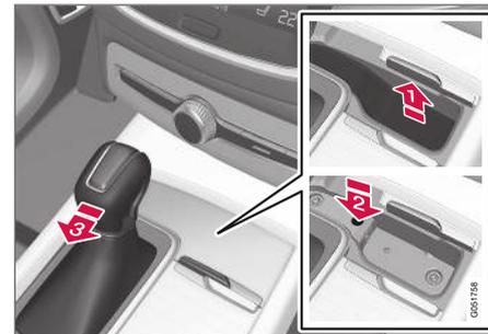
Si la voiture ne peut être conduite, par ex. lorsque la batterie est déchargée, mettez le sélecteur de vitesses en position **N** pour pouvoir déplacer la voiture.
