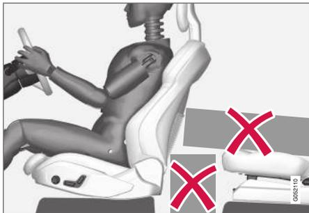
Ne placez jamais d'objets sur le plancher derrière ou sous les sièges avant ou la banquette arrière qui pourraient gêner le fonctionnement du système WHIPS.
