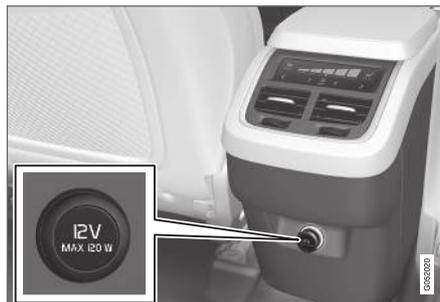
Prise électrique 12 V sur la console de tunnel, deuxième rangée de sièges.
