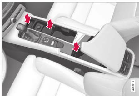
Compartiments de rangement avec porte-gobelets, prise électrique et port USB dans la console tunnel.
