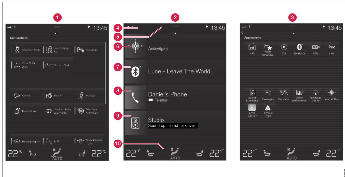
Trois des vues élémentaires de l'écran central. Balayer à droite ou à gauche permet d'accéder respectivement à la vue Fonctions et à la vue Applications<sup>9</sup>.
