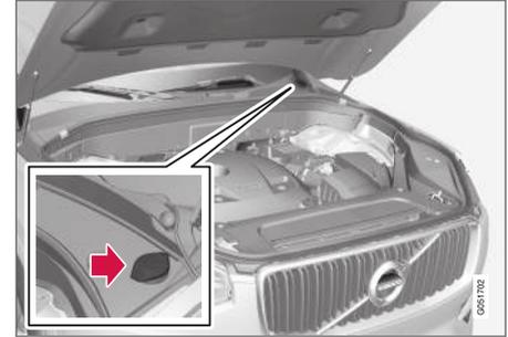
L'ajout de liquide lave-glace s'effectue par l'ouverture avec le bouchon bleu. Le réservoir est utilisé pour le lave-glace de pare-brise et lunette arrière ainsi que pour les lave-phares\*
