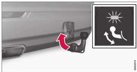
Verrouillez le crochet en le repoussant en position rentrée, où il se verrouillera.
