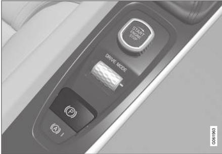
La commande de frein de stationnement se trouve sur la console de tunnel, entre les sièges.
