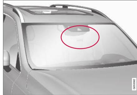
La zone indiquée ne doit pas être couverte (ni autocollant, ni filtre solaire, ni aucun autre objet, etc.)<sup>77</sup>.
