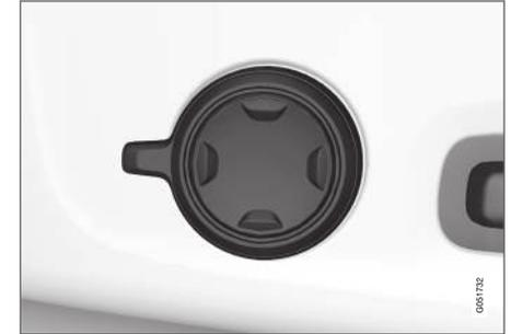
Commande multifonctions placée sur le côté de l'assise du siège.
