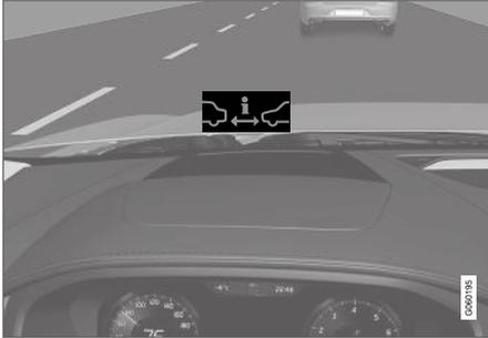
Symbole pour contrôle de la distance sur le pare-brise<sup>37</sup>.
