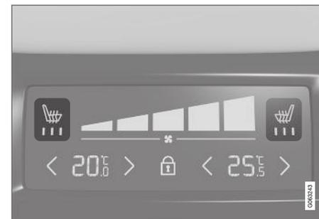
Témoignage de siège chauffant et panneau de commandes climatiques arrière, sur la console de tunnel.
