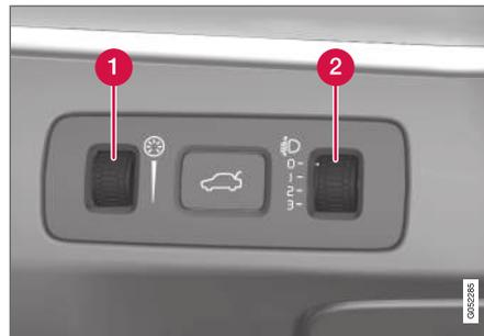
Les voitures équipées de phares LED<sup>2\*</sup> possèdent un réglage automatique de la portée et ne comportent donc pas de molette pour le réglage de portée.
