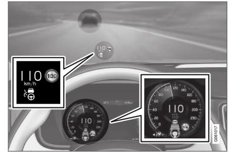
L'illustration précédente<sup>72</sup> indique que Pilot Assist est réglé pour maintenir une vitesse de 110 km/h (68 mph) et qu'il suit un véhicule qui roule à la même vitesse.
