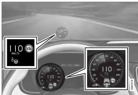
L'illustration précédente<sup>72</sup> indique que Pilot Assist est réglé pour maintenir une vitesse de 110 km/h (68 mph) et qu'il n'y a aucun véhicule à suivre.
