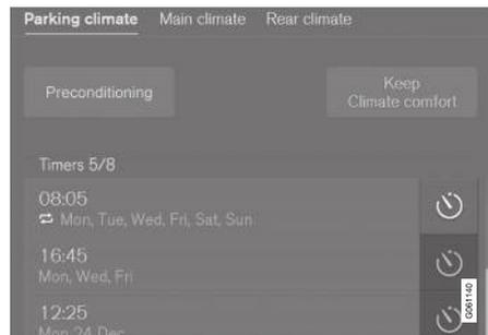
Boutons de minuterie dans l'onglet **Climatisation à l'arrêt** de la vue Climatisation.
