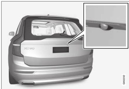
La caméra<sup>122</sup> arrière est placée au-dessus de la plaque d'immatriculation.
