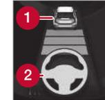
Ce n'est que lorsque le symbole de volant (2) passe de GRIS à VERT que la correction de trajectoire Pilot Assist est active.
