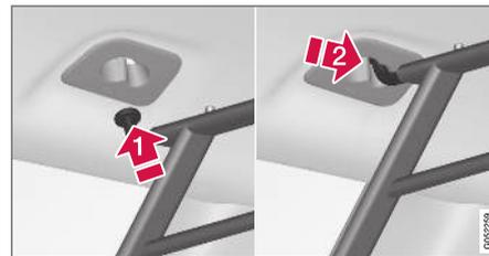
2. Insérez l'un des crochets de la grille de protection dans la grosse ouverture de la fixation du toit (1).
