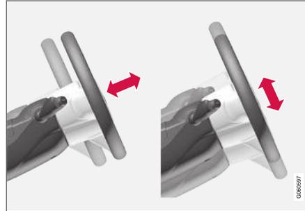
Le volant peut être réglé en profondeur et en hauteur.
