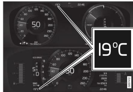
Emplacement de l'indicateur de température extérieure sur les écrans conducteur 12 pouces et 8 pouces.
