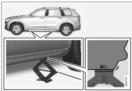
9. Placez le cric sur une surface plane, ferme et non glissante, et sous le point de fixation à utiliser.
