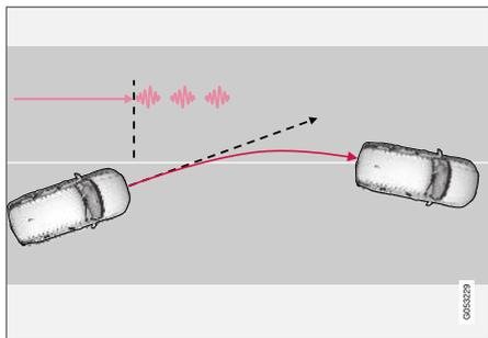
L'assistance de sortie de voie avertit le conducteur par des vibrations dans le volant<sup>111</sup>.
