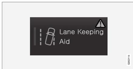
L'apparition d'un triangle d'avertissement apparaît dans la partie supérieure du bouton indique une anomalie.
