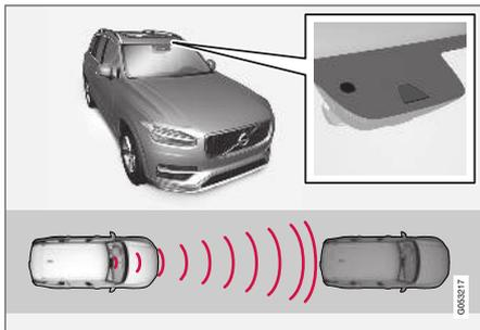
L'unité de caméra/radar mesure la distance au véhicule qui précède<sup>45</sup>.
