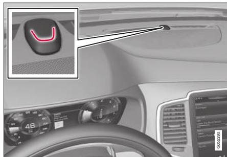
Une diode rouge sur le tableau de bord indique l'état du système d'alarme :
