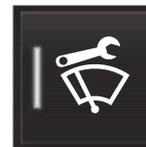
Appuyez sur le bouton **Posit. entretien essuie-glace**. Le témoin du bouton s'allume lorsque la position d'entretien est activée. À son activation, les essuie-glace montent et restent en position verticale. Pour
