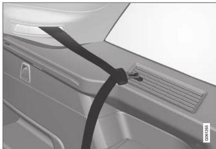
Accrochez les boucles des ceintures de sécurité des sièges de la troisième rangée aux crochets prévus à cet effet situés sur les panneaux latéraux.
