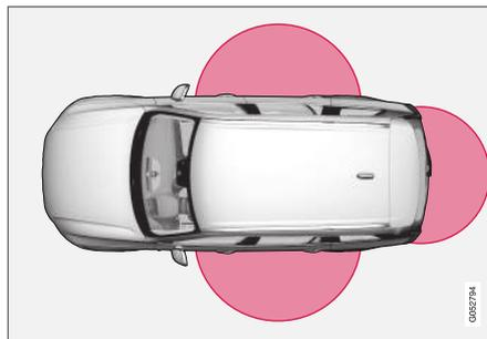
Les parties grisées sur l'illustration indiquent les zones couvertes par les antennes du système.
