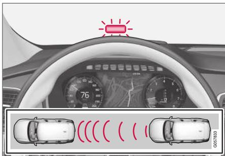
Avertissement lumineux pour le contrôle de la distance sur le pare-brise<sup>35</sup>.
