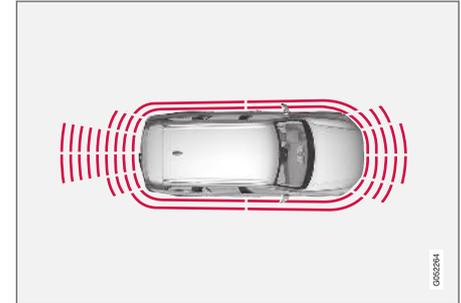
Les capteurs latéraux de l'aide au stationnement sont automatiquement activés au démarrage du moteur. Ils sont activés lorsque la vitesse est inférieure à 10 km/h (6 mph).
