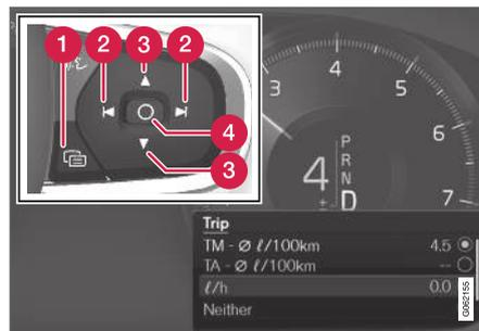
Utilisez les commandes au volant droites pour ouvrir le menu d'application<sup>2</sup> et y naviguer.
