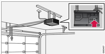
4. Cherchez le bouton d'apprentissage<sup>21</sup> sur le récepteur de la porte de garage par exemple. Il est généralement placé près de la fixation de l'antenne sur le récepteur.
