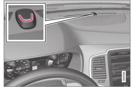
Une diode lumineuse rouge du tableau de bord clignote une fois toutes les deux secondes lorsque la voiture est verrouillée et lorsque l'alarme est activée.
