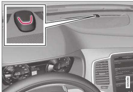
Le témoin de verrouillage et d'alarme sur le tableau de bord indique le statut du système de verrouillage.
