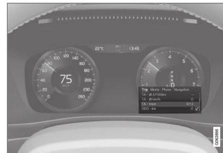
Le menu d'applications de l'écran conducteur est utilisé à la place de l'écran central. L'illustration est schématisée, la configuration peut être différente.
