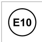
L'E10 est un type d'essence avec un taux d'oxygène maximale de 3,7 % et un taux d'éthanol maximale de 10 %.
