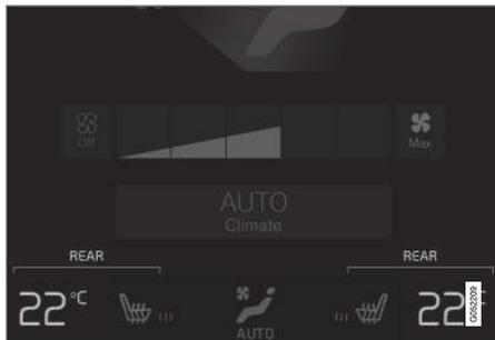
Boutons de température dans l'onglet **Climatisation arrière** de la vue Climatisation.
