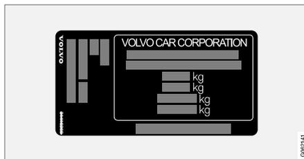
codes de peinture extérieure et numéro d'homologation de type. L'autocollant se trouve sur le montant de porte et visible à l'ouverture de la porte arrière droite.
