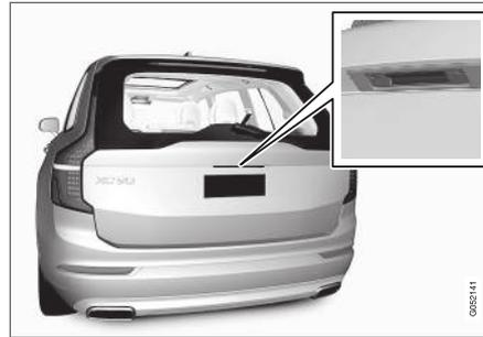
Le bouton gainé de caoutchouc sur le hayon ne sert qu'au déverrouillage.
