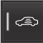
Appuyez sur le bouton **Protection réduite** dans la vue Fonctions de l'écran central pour désactiver les capteurs de mouvement et d'inclinaison lors du verrouillage suivant de la voiture.
