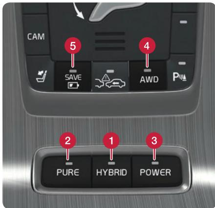
Das Fahrzeug verfügt über zwei Motoren – einen Elektro- und einen Dieselmotor. Sie können keinen „falschen“ Fahrmodus wählen – wenn bestimmte Bedingungen nicht erfüllt sind, wechselt das Fahrzeug wieder in den HYBRID-Modus. In diesem Fall leuchtet die Lampe in der Hybrid-Taste auf.
