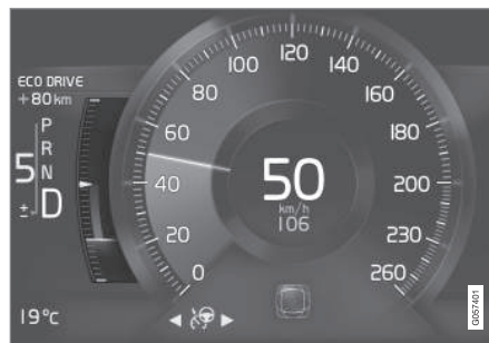
Medidor ECO no mostrador do condutor 8 polegadas.
