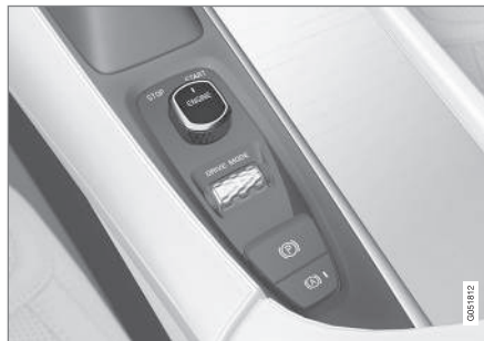
Disco de arranque na consola de túnel.
