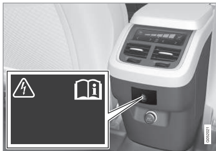
Tomada eléctrica 230 V na consola de túnel, segunda fila de bancos.
