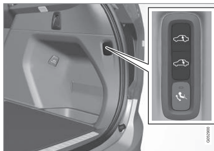
Comando para subida/descida da secção traseira do automóvel.
