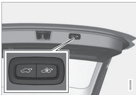
Botão para fecho e trancagem no lado inferior da tampa do porta-bagagens.
