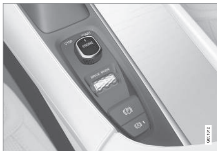
Disco de arranque na consola de túnel.
