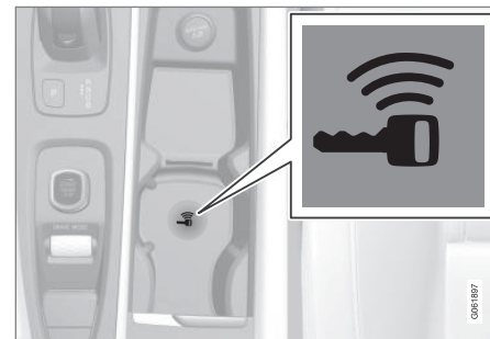
Umístění záložní čtečky v tunelové konzole.
