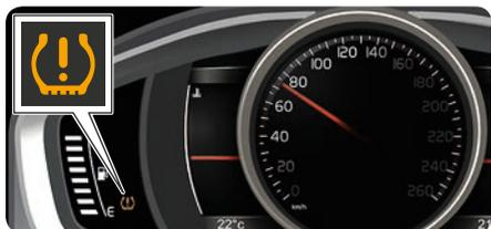
更換輪胎或改變胎壓後，務必進行校正。若燈光照明時 (⚠) 需要檢查胎壓並校正系統。依據下列步驟進行：
