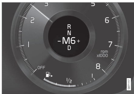
Vue d'ensemble de la grille de rapports dans l'écran du conducteur - avec petit levier de vitesses.
