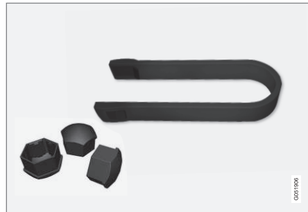
Plastikinių dangtelių nuėmimo nuo ratų varžtų įrankis.
