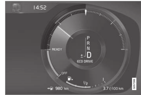
ECO-meter op 12 inch bestuurdersdisplay*.
