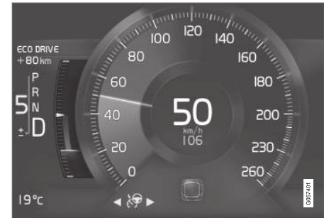
ECO-meter op 8 inch bestuurdersdisplay.
