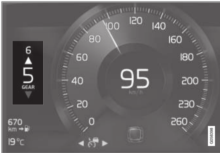
Schakelindicator op 8 inch bestuurdersdisplay.
