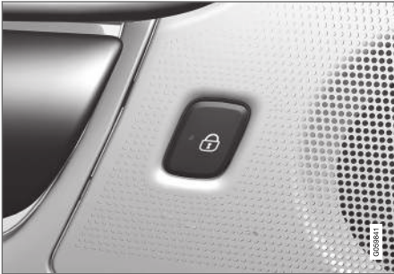
Knop voor vergrendelen in achterportier met led.
