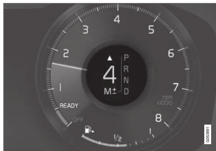
Schakelindicator op 12 inch bestuurdersdisplay*.
