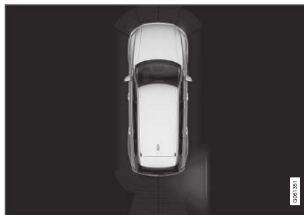
Brandend pictogram voor CTA in de grafische PAS-voorstelling 95 op het display.
