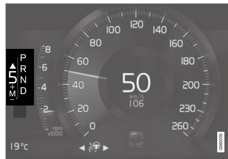
Schakelindicator op 8 inch bestuurdersdisplay.
