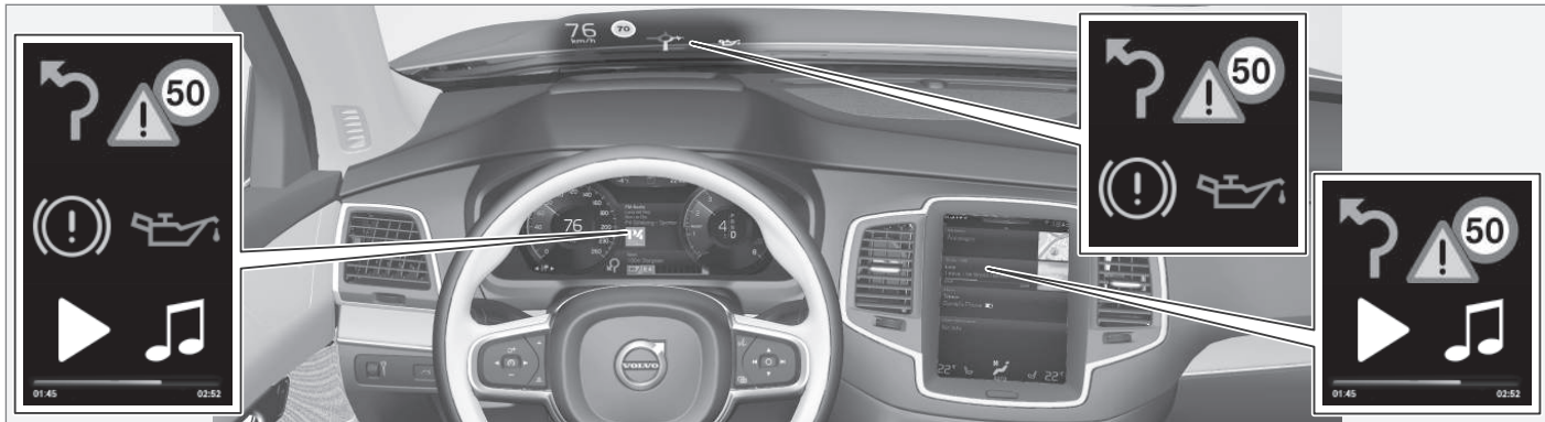
Forskellige typer information vises på forskellige display, afhængigt af hvordan informationen skal prioriteres.
