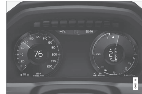
Førerdisplayet viser oplysninger om bl.a. hastighed og f.eks. indgående opkald, eller oplysninger
