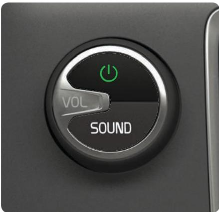
Beachten Sie, dass das gesamte Sensus-System (einschließlich Navigations-<sup>\*</sup> und Telefonfunktionen<sup>\*</sup>) ein- bzw. ausgeschaltet wird.
