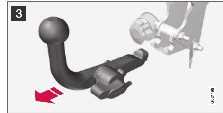
3 Поверните вниз до упора стопорную ручку и, удерживая ее, одновременно выньте шаровое устройство назад и вверх.
