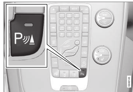
Переключатель датчиков системы помощи при парковке и СТА.
