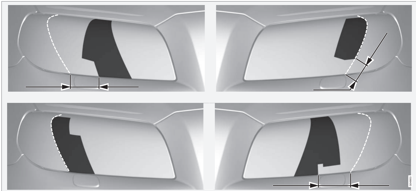
上一行：左座駕駛汽車，樣板 A 和 B。下一行：右座駕駛汽車，樣板 C 和 D。
