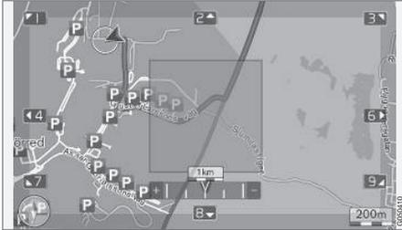
1. Dans la vue normale du système de navigation, appuyer sur la **molette/OK/MENU** et sélectionner **Paramètres → Options de trajet → Éviter la zone → Sélectionner la zone sur la carte**.
