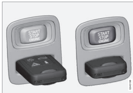
Startlås med fjärrnyckel utdragen/intryckt.
