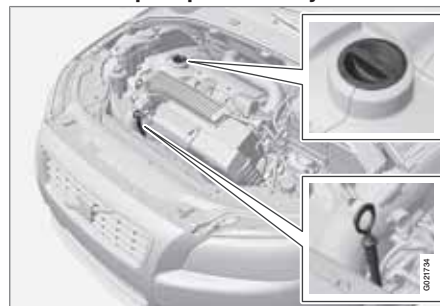
Peilepinne og påfyllingsrør.
