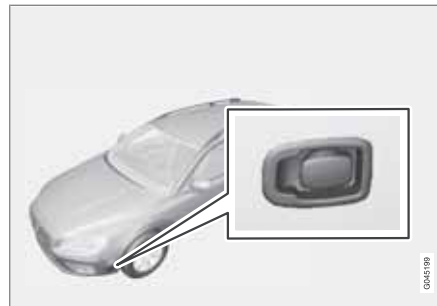
Strøminntak for motorvarmer.
