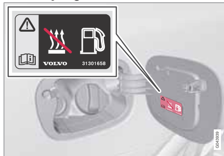
Varselmerke på tanklokket.
