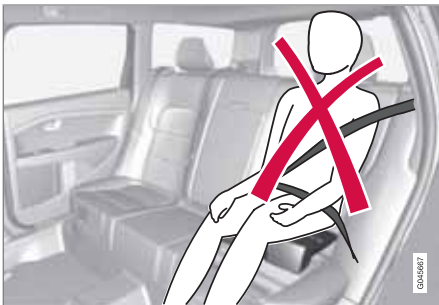
Feil plassering, hodet må ikke være over hodestøtten og beltet må ikke gå nedenfor skuldrene.
