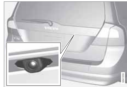
Kameraets plassering like ved åpningshåndtaket.
