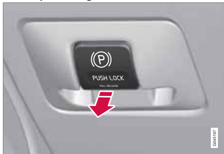
Parkeringsbremsbryter - løs bremsen.
