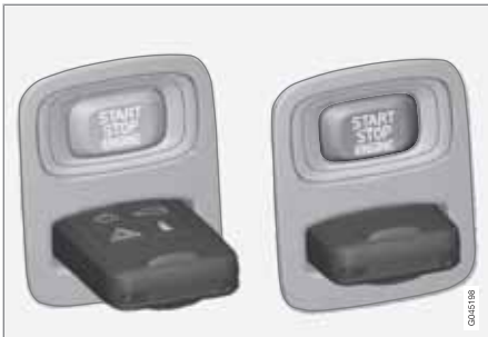
Startlås med fjernkontrollnøkkel trukket ut/trykt inn.
