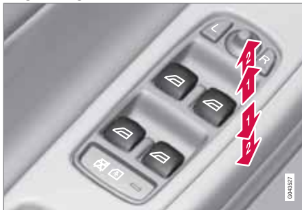
Regulering av vindusheiser.
