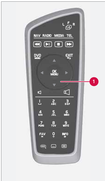
1 Scrollhjul, tilsvarende TUNE i midtkonsollen.
