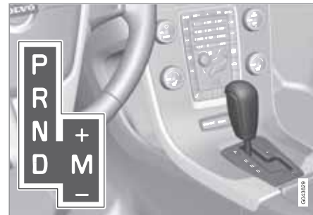
D: Automatiske gir. M (+/-): Manuelle gir.
