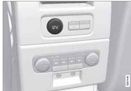
12 V-uttak i tunnelkonsoll, baksete.
