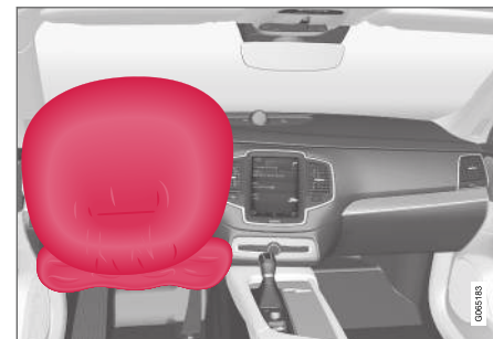
Coussin gonflable dans le volant et coussin gonflable de genoux du siège avant, côté conducteur.
