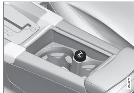
12 V-uttak i tunnelkonsoll, forsete.
