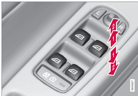
Regulering av vindusheiser.
