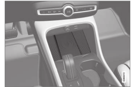
Draadloze telefoonoplader vóór de schakelhendel
