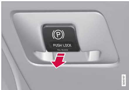
Parkeringsbremsbryter - løs bremsen.
