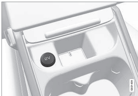
12 V-uttak i tunnelkonsoll, forsete.
