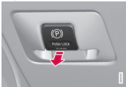
Przełącznik hamulca postojowego – wyłączenie.
