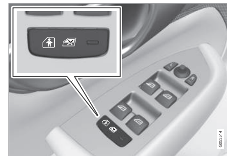
Botón de conexión y desconexión eléctrica.
