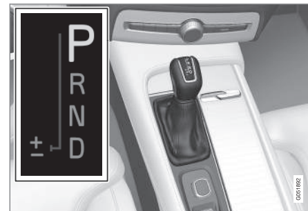
Visión general de palanca de cambios grande y patrón de cambios en la pantalla del conductor.
