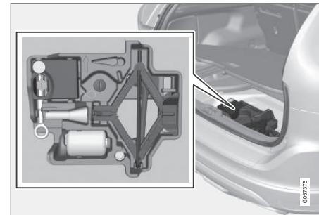
Sotto il pianale di carico sono riposti l'occhiello di traino, il martinetto\* e la chiave per le colonnette\*. Qui c'è anche spazio per il chiave delle colonnette bloccabili e l'attrezzo per i cappucci di plastica delle colonnette.
