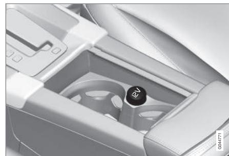
Presa da 12 V nel tunnel, sedile anteriore.
