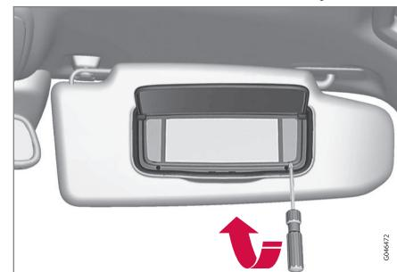
1. Inserire un cacciavite sotto la lente della lampadina e sollevare con cautela i fermi sul bordo.
