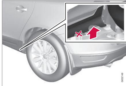
Controllare che il martinetto sia ben fissato come in figura e che il piede sia posizionato verticalmente sotto l'attacco.
