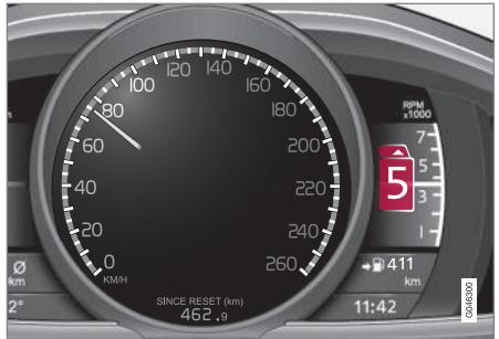
Quadro strumenti "Digital" con Indicatore cambio di marcia.
