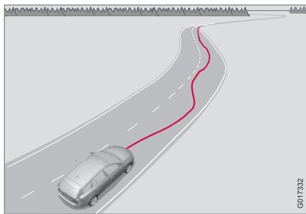
Una telecamera rileva le strisce dipinte di delimitazione della corsia di marcia e confronta il loro andamento con i movimenti del volante. Il conducente viene avvertito quando l'automobile non segue in modo regolare la corsia di marcia.
