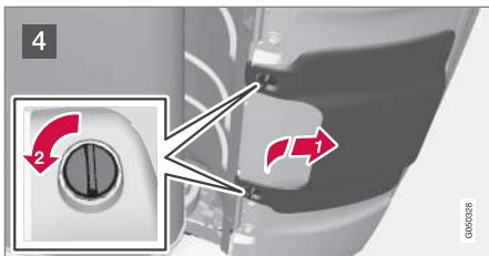
**4** Reinstallare la copertura inserendo i relativi ganci nel bordo posteriore del paraurti. Premere la copertura verso l'alto finché le viti non si trovano nella posizione corretta **1**. Infine, avvitare le viti di un quarto di giro **2** per fissare la copertura. Durante il montaggio, è importante che le viti siano in posizione opposta.
