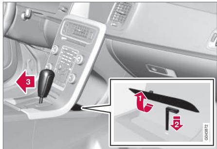
Se non è possibile guidare l'automobile, ad esempio perché la batteria di avviamento è scarica, occorre uscire dalla posizione **P** della leva selettrice per spostare l'automobile.
