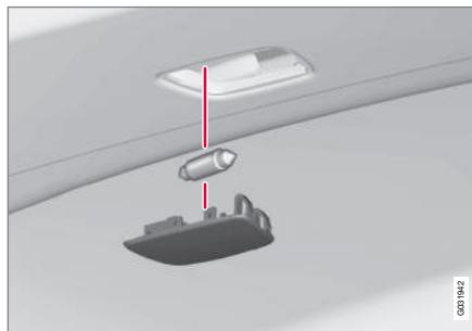
1. Inserire un cacciavite e fare leva delicatamente per staccare l'alloggiamento lampadina.
