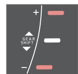
Indicatore cambio di marcia per cambio manuale. È acceso un solo indicatore alla volta; durante la guida normale è acceso solo quello al centro.
