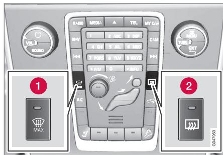
**1** Riscaldamento elettrico del parabrezza
