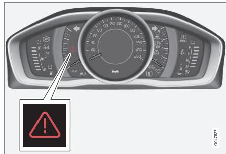
Triangolo di avvertimento nel quadro strumenti analogico.
