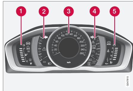
**1** Indicatore del carburante. Quando l'indicatore scende a una tacca bianca<sup>1</sup>, si accende la spia gialla di controllo per basso livello di carburante nel serbatoio. Vedere anche Computer di bordo (p. 123) e Rifornimento carburante (p. 315).
