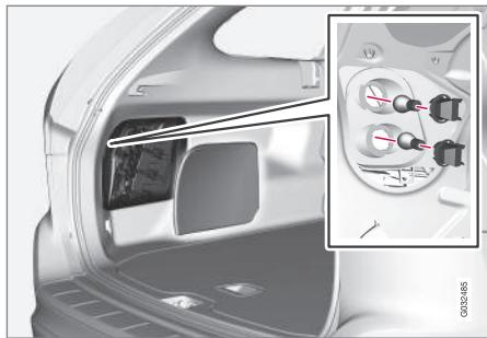
Le lampadine delle luci di arresto e retromarcia si sostituiscono dall'interno del bagagliaio.
