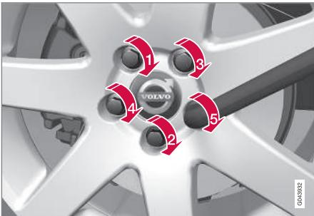
4. Serrare i dadi della ruota in sequenza. È importante serrare i dadi alla coppia corretta. Serrare a 140 Nm. Controllare la coppia con una chiave torsiometrica.
