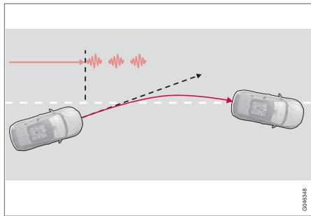
La funzione LKA sterza e avverte il conducente mediante vibrazioni nel volante<sup>28</sup>.
