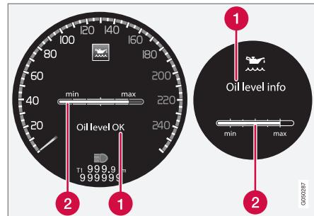
Messaggio e grafico sul display. Il display sinistro è visualizzato nel quadro strumenti digitale e quello destro nel quadro strumenti analogico.
