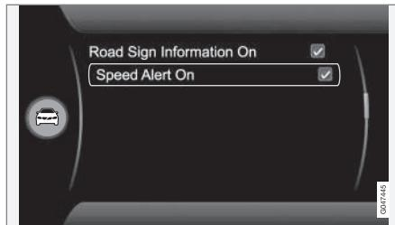
Il conducente può attivare un avvertimento che viene fornito qualora si superi il limite di velocità di 5 km/h (5 mph) o più. L'avvertimento è rappresentato dal lampeggi del simbolo del limite di velocità per tutto il tempo in cui detta velocità è superata. La funzione può essere attivata/disattivata nel menu **MY CAR**. Per la descrizione del menu, vedere MY CAR (p. 121).
