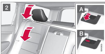
**1** Se lo schienale centrale può essere ribaltato; disin impegnare e abbassare il poggiatesta dello schienale centrale; consultare la precedente sezione "Poggiatesta posteriore centrale".
