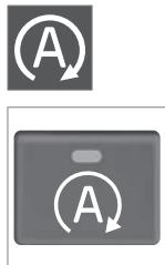
La funzione Start/Stop si attiva automaticamente all'accensione del motore con la chiave. Il conducente è avvertito di ciò mediante l'accensione della spia della funzione nel quadro strumenti e della spia del pulsante On/Off.
