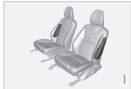
Il sistema airbag SIPS comprende due parti principali: airbag laterali e sensori. L'airbag laterale è posizionato nello schienale anteriore.
