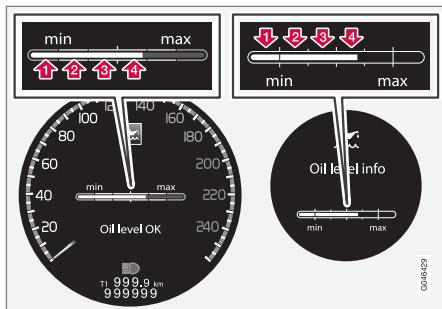
I numeri 1-4 indicano il livello di riempimento. Non rabbocco olio se è visualizzato il livello di riempimento (3) o (4). Il livello di riempimento raccomandato è 4.
