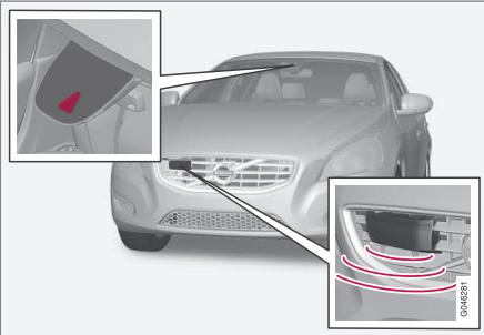
Sensore telecamera e radar<sup>21</sup>.
