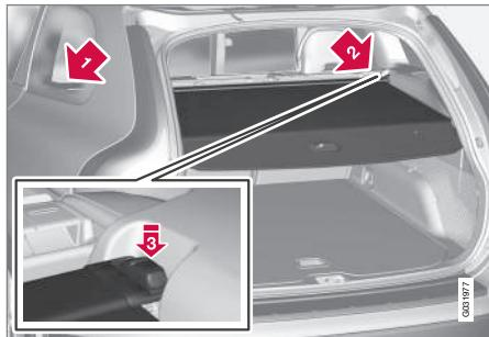
Tirare il copribagagliaio sopra i bagagli e agganciarlo alle scanalature sui montanti posteriori del bagagliaio.
