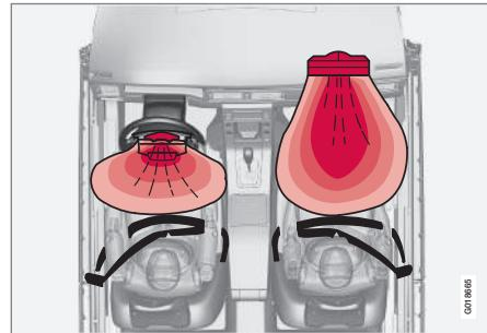
Vista dall'alto del sistema airbag, automobile con guida a sinistra.
