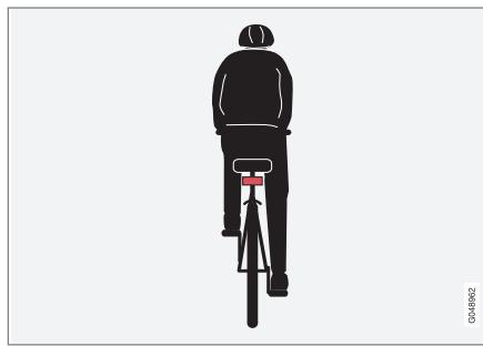
Esempio ideale di una figura che il sistema interpreta come un ciclista: con il profilo di corpo e bicicletta chiaramente rilevabile da dietro e sulla linea centrale dell'automobile.
