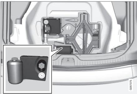
Il kit di riparazione pneumatici è collocato sotto il pavimento del bagagliaio.
