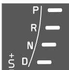
Le posizioni del cambio automatico sono indicate a destra sul quadro strumenti. (È acceso un solo indicatore alla volta, cioè quello per la posizione attuale del selettore.)
