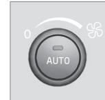
Ruotare la manopola per aumentare o ridurre la velocità della ventola. Se si seleziona **AUTO**, la velocità della ventola si regola automaticamente (p. 144) - la velocità della ventola precedentemente impostata viene disinserita.
