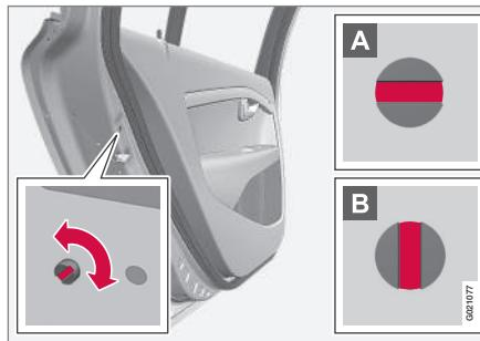
Il comando del fermo di sicurezza per bambini si trova sul bordo posteriore delle portiere posteriori ed è accessibile solo con la portiera aperta.
