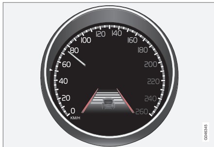
LDW-funktionens sidemarkeringer (markeret med rødt på billedet).
