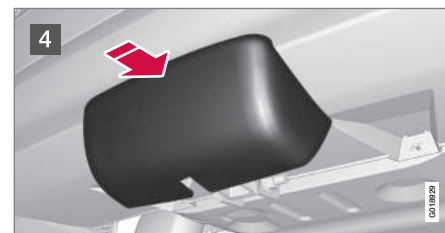
4 Poussez le cache de protection jusqu'à ce qu'il s'enclenche.
