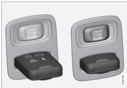
Contactslot met transpondersleutel uitgetrokken/ingeduwd.
