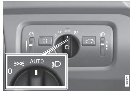
Verlichtingsdraaiknop in stand AUTO .
