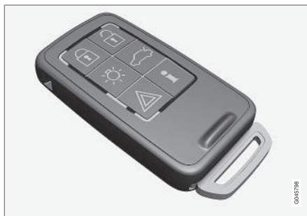
Transpondersleutel met PCC* (Personal Car Communicator).
