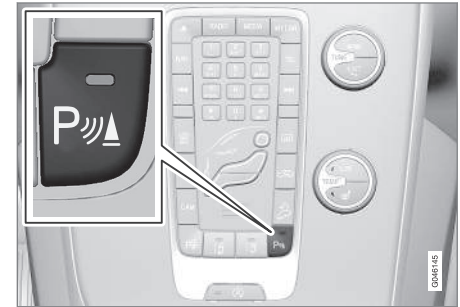
Aan/Uit sensoren voor Park Assist en CTA 33 .
