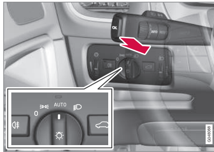
Stuurhendel en verlichtingsdraaiknop in stand AUTO .
