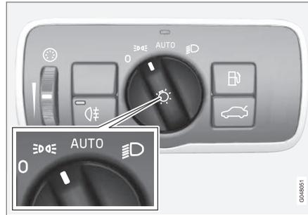
Drehregler des Lichtschalters in Stellung für Positionsleuchten/Standlicht.
