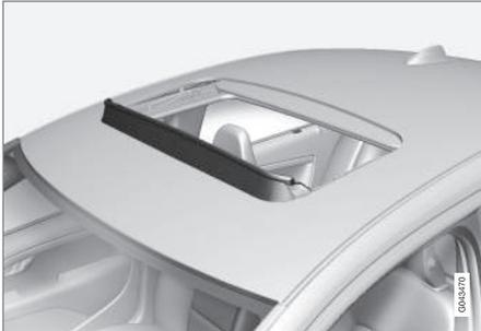
Zum Schiebedach gehört ein Windabweiser, der bei geöffnetem Schiebedach hochklappt wird.
