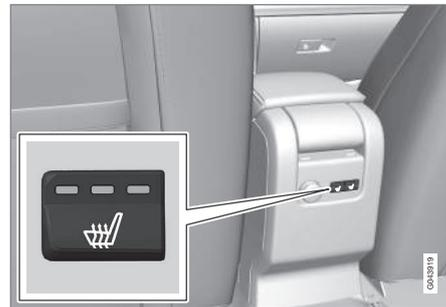
Die aktuelle Heizleistung wird in den Lampen der Druckschalter angezeigt.
