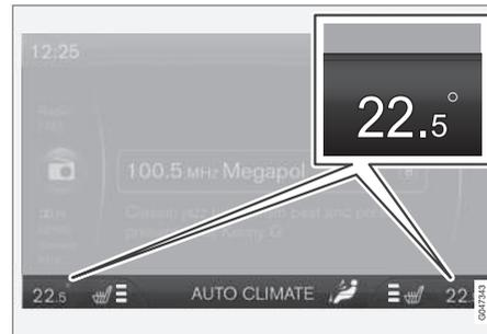
Die aktuelle Temperatur für jede Seite wird auf dem Bildschirm der Mittelkonsole angezeigt.
