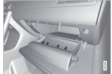
Hier können beispielsweise die Betriebsanleitung des Fahrzeugs und Straßenkarten aufbewahrt werden. Auf der Innenseite der Klappe ist ein Halter für Stifte vorhanden. Das Handschuhfach kann verriegelt\* (S. 184) werden, indem das Schlüsselblatt (S. 173) verwendet wird.
