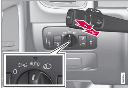
Lenkradhebel und Lichtschalter-Drehregler.
