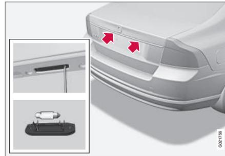
1. Die Schrauben mit einem Schraubendreher lösen.
