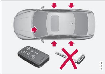
Verriegelungspunkte für Transponderschlüssel **ohne** Schlüsselblatt und **aktiverter** Geheimverriegelung.
