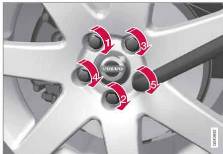
4. Die Radschrauben über Kreuz festziehen. Es ist wichtig, dass die Radschrauben ordentlich festgezogen werden. Mit 140 Nm festziehen. Das Anzugsdrehmoment mit einem Drehmomentschlüssel überprüfen.
