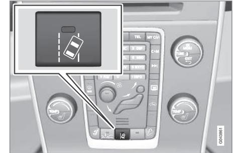
Auf die Taste in der Mittelkonsole drücken, um die Funktion ein- bzw. auszuschalten. Die Taste leuchtet wenn die Funktion eingeschaltet ist.
