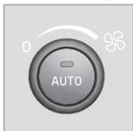
Mit dem Drehregler wird die Gebläsegeschwindigkeit erhöht oder gesenkt. Bei der Wahl von **AUTO** wird die Gebläsegeschwindigkeit automatisch (S. 140) geregelt - die zuvor eingestellte
