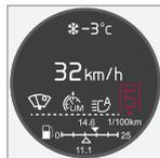
Bei dem Kombinationsinstrument "Analog" werden die Schaltstellung und die Anzeigepfeile in der Mitte angezeigt.
