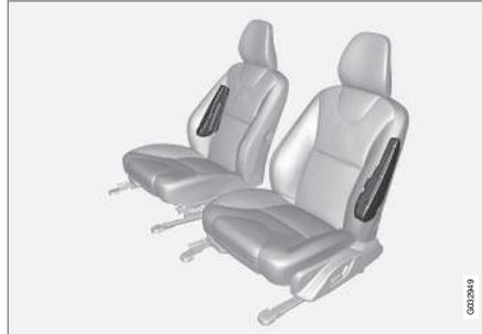
Das SIPS-Airbag-System besteht aus zwei Hauptteilen, Seitenairbags und Sensoren. Der Seitenairbag ist im Rückenlehnenrahmen des Vordersitzes eingebaut.
