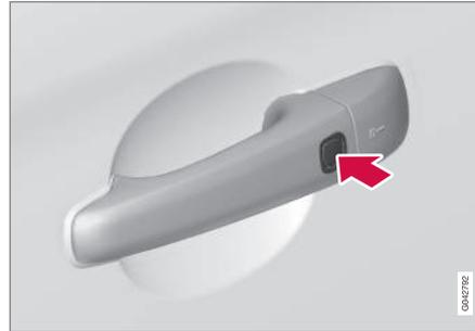
Fahrzeuge mit Keyless-System verfügen über eine Taste an den Außentürgriffen.
