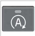
In bestimmten Situationen ist es wünschenswert, die automatische Start/Stop-Funktion vorübergehend ausschalten zu können – dies erfolgt mit einem Druck auf diese Taste.
