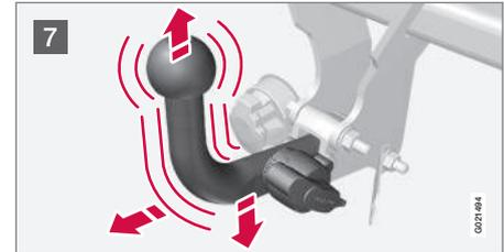
7 Sicherstellen, dass die Anhängerzugvorrichtung fest sitzt: Diese dazu hoch-, herunter- und zurückbewegen.
