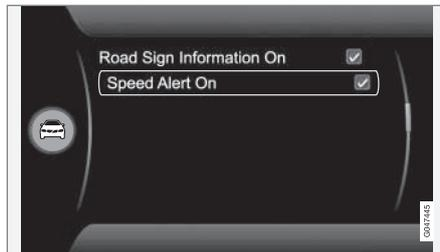
Der Fahrer kann auf Wunsch eine Warnung erhalten, wenn die geltende Geschwindigkeitsbegrenzung um 5 km/h oder mehr überschritten wird. Die Warnung zeigt sich dadurch, dass das Symbol mit der geltenden Höchstgeschwindigkeit bei Überschreitung der Geschwindigkeit blinkt. Die Funktion kann im Menüsystem **MY CAR** aktiviert/deaktiviert werden. Mehr zur Beschreibung des Menüsystems siehe MY CAR (S. 117).
