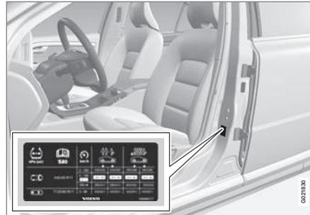
Auf dem Reifendruckaufkleber an der Türsäuleninnenseite auf der Fahrerseite (zwischen Vorder- und Fondtür) ist der bei unterschiedlicher Beladung und unterschiedlichen Geschwindigkeitsverhältnissen geltende Reifendruck angegeben. Der Reifendruck ist außerdem in der Reifendrucktabelle angegeben, siehe Reifen - zugelassener Reifendruck (S. 432).
