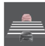
Nur wenn das Symbol das Bild eines anderen Fahrzeugs zeigt, wird der **Abstand** zum vorausfahrenden Fahrzeug durch den ACC reguliert.
