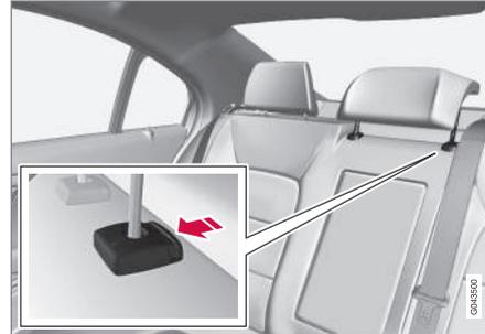
Die Kopfstütze an die Körpergröße des Insassen anpassen. Die obere Kante der Kopf-
