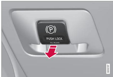
Feststellbremsregler - lösen.
