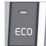
Ist die ECO-Funktion deaktiviert, erlöschen das ECO-Symbol auf dem Kombinationsinstrument und die Beleuchtung der ECO -Taste. Damit ist die Funktion deaktiviert, bis sie durch erneutes Drücken der ECO -Taste wieder aktiviert wird.
