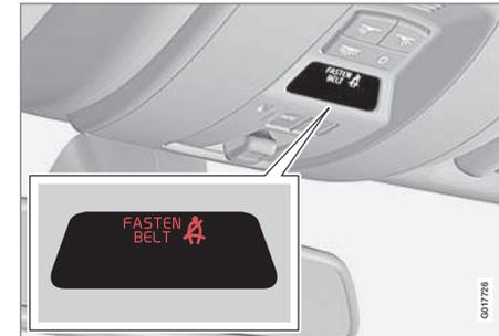
Das akustische Signal ist geschwindigkeitsabhängig und in bestimmten Fällen zeitabhängig. Das optische Signal befindet sich in der Dachkonsole und im Kombinationsinstrument (S. 63).
