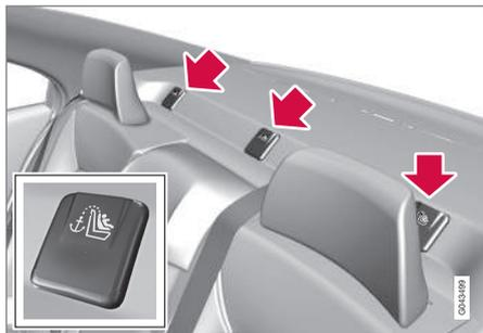
In Fahrzeugen mit umklappbaren Kopfstützen an den Außenplätzen sollten die Kopfstützen zur Erleichterung des Einbaus umgeklappt werden.
