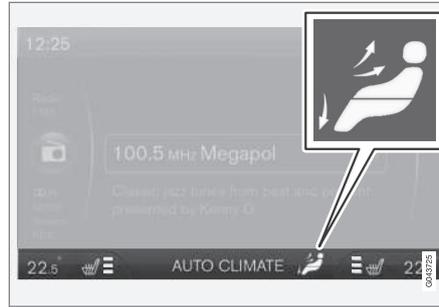
Die gewählte Luftverteilung wird im Bildschirm der Mittelkonsole angezeigt.
