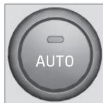
Bei Auswahl von einer oder mehreren manuellen Funktionen werden die übrigen Funktionen weiterhin automatisch gesteuert. Durch Drücken auf **AUTO** werden sämtliche manuellen Einstel-
