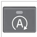
Alle gewöhnlichen Systeme des Fahrzeugs wie die Beleuchtung, das Radio usw. funktionieren auch bei automatisch gestopptem Motor normal. Ausgenommen ist bestimmte Ausrüstung, deren Funktion vorübergehend reduziert wird, wie z.B. die Gebläsegeschwindigkeit der Klimaanlage oder eine extrem hohe Lautstärke der Stereoanlage.
