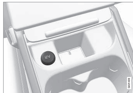
12 voltos aljzat az alagútvezetőben, első ülés.
