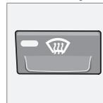
Para eliminar rápidamente el vaho y el hielo del parabrisas y de las ventanillas. Las ventanillas se ventilan a alta velocidad. Cuando está conectada esta función, se enciende la luz del botón del desempañador.
