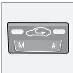
La función se selecciona para impedir la entrada de aire contaminado, gases de escape etc. en el habitáculo. El aire del habitáculo recircula, es decir, no entra en el automóvil aire del exterior
