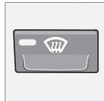
Para eliminar rápidamente el vaho y el hielo del parabrisas y de las ventanillas. Las ventanillas se ventilan a alta velocidad. Cuando está conectada esta función, se enciende la luz del botón del
