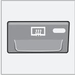
Utilice la función de calefacción eléctrica para hacer desaparecer el hielo y el vaho de la luneta trasera y los retrovisores. Si pulsa el botón una vez, se inicia el calentamiento de la luneta trasera y los retrovisores al mismo tiempo. La luz del botón se
