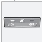
**ON:** El aire acondicionado está conectado. El sistema se regula automáticamente. De esta manera, el aire que entra se enfría y deshumedece.
