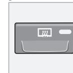
Utilice la función de calefacción eléctrica para hacer desaparecer el hielo y el vaho de la luneta trasera y los retrovisores. Si pulsa el botón una vez, se inicia el calentamiento de la luneta trasera y los retrovisores al mismo tiempo.
