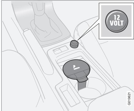
La toma eléctrica puede utilizarse con diversos accesorios previstos para una tensión de 12 V, por ejemplo, un teléfono móvil o una nevera. Para que la toma suministre corriente, la llave debe estar como mínimo en la posición I.
