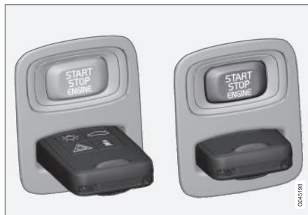
Contacteur d'allumage avec télécommande retirée/insérée.
