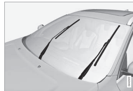
Balais d'essuie-glace en position d'entretien.
