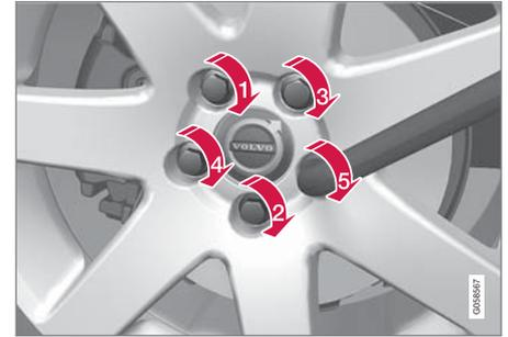
4. ชันแป้นเกลียวล้อตามแนวกากบาท สิ่งที่สำคัญก็คือ จะต้องขันน็อตล้อโดยใช้แรงบิดที่ถูกต้อง ตรวจสอบแรงบิดโดยใช้ประแจปอนด์
