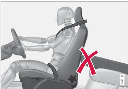
ห้ามวางวัตถุใดๆ ไว้บนเบาะนั่งด้านหลังที่อาจกีดขวางไม่ให้ระบบ WHIPS ทำงาน
