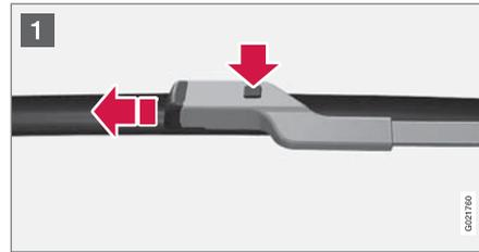
1. พับก้านที่ปัดน้ำฝนขึ้นเมื่ออยู่ในตำแหน่งบริการ กดปุ่มบนที่ยึดใบปัดน้ำฝน และดึงออกตรงๆ ขนานกับก้านปัดน้ำฝน
