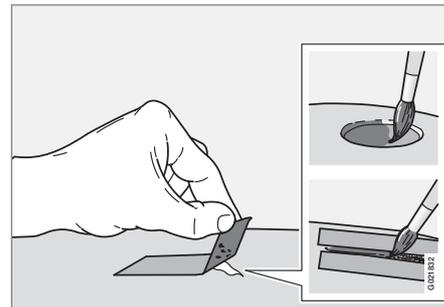
ก่อนทำการซ่อมสี จะต้องทำความสะอาดและปล่อยให้แห้ง และรถจะต้องอยู่ในที่มีอุณหภูมิสูงกว่า 15 °C
