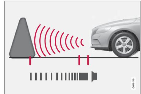
ระยะที่ครอบคลุมถึงทางด้านหน้าของรถคือ ประมาณ 0.8 เมตร สัญญาณเสียงสำหรับสิ่งกีดขวางด้านหน้าจะมาจากลำโพงตัวใดตัวหนึ่งที่อยู่ด้านหน้า
