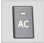
เมื่อไฟแสดงในปุ่ม AC สว่าง ระบบปรับอากาศถูกควบคุมโดยการทำงานอัตโนมัติของระบบ
