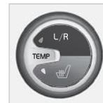
อุณหภูมิด้านคนขับและด้านผู้โดยสารสามารถตั้งได้แยกกัน กด L/R ในปุ่มซ้ายๆ เพื่อเลือกการตั้งค่าสำหรับด้านซ้าย, ด้านขวา หรือทั้งสองด้าน ตั้งอุณหภูมิโดยใช้ปุ่มหมุน
