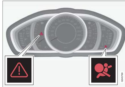
สัญลักษณ์เตือนรูปสามเหลี่ยมและสัญลักษณ์เตือนสำหรับระบบถุงลมนิรภัย (น. 37) ในแผงหน้าปัดแบบรวมแบบอนาล็อก
