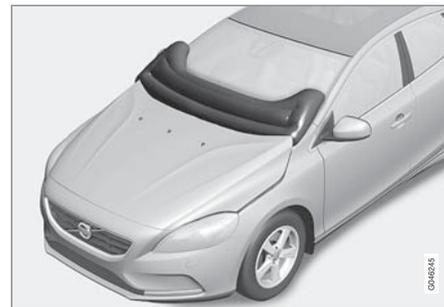
ถุงลมนิรภัยสำหรับคนเดินถนน Pedestrian Airbag ติดตั้งอยู่ใต้ฝากระโปรงหน้าบริเวณใกล้กับกระจกหน้า ในกรณีที่เกิดการชนคนเดินถนนด้านหน้าในระดับหนึ่ง เซ็นเซอร์ในกันชนหน้าจะทำงาน และถ้าจำเป็นถุงลมนิรภัยจะพองตัวขึ้นอยู่กับความแรงในการชน เซ็นเซอร์จะทำงานที่ความเร็วประมาณ 20-50 กม./ชม. (12-30 ไมล์ต่อชั่วโมง) และอุณหภูมิอากาศภายนอกอยู่ระหว่าง -20 และ +70°C
