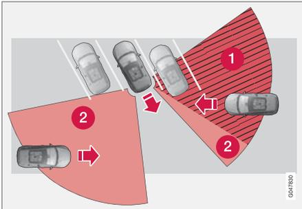
ในช่องจอดรถที่เป็นมุม CTA อาจ "มองไม่เห็นสิ่งใดเลย" ที่ด้านหนึ่งได้
