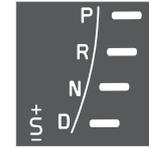
ตำแหน่งเกียร์อัตโนมัติจะแสดงขึ้นที่ด้านขวาของแผงหน้าปัดแบบรวม (เครื่องหมายจะติดสว่างขึ้นเพียงครั้งละหนึ่งเครื่องหมายเท่านั้น ซึ่งก็คือเครื่องหมายที่แสดงตำแหน่งคัน
