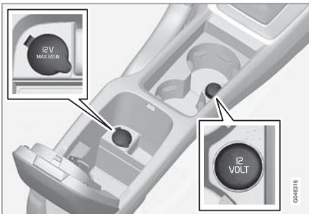
ช่องจ่ายไฟ 12 โวลต์ ในช่องเก็บสัมภาระในคอนโซลกลาง เบาะนั่งด้านหน้า
