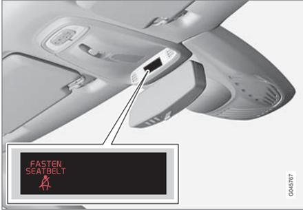
เสียงเตือนจะขึ้นอยู่ด้วยความเร็วและในบางกรณีจะขึ้นอยู่ กับเวลา สัญญาณเตือนจะแสดงอยู่ในคอนโซลบริเวณ หลังคาและในแผงหน้าปัดแบบรวม (น. 76)
