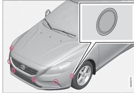
เซ็นเซอร์ PAP จะอยู่ในกันชน<sup>44</sup> โดยมี 6 ตัวที่ด้านหน้าและ 4 ตัวที่ด้านหลัง
