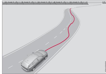
ถ้ารถจะตรวจจับเครื่องหมายด้านข้างที่ทาไว้บนเลน และเปรียบเทียบส่วนถนนกับการเคลื่อนพวงมาลัยของคนขับ คนขับจะถูกเตือนหากรถไม่วิ่งตามเลนอย่างสม่ำเสมอ
