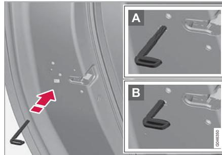
การล็อกประตูด้วยมือ อย่าสับสนกับล็อกนิรภัยสำหรับเด็ก (น. 221)
