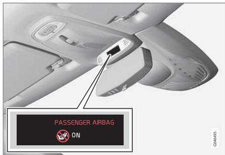
ไฟแสดงจะแสดงว่าถุงลมนิรภัยผู้โดยสารถูกกระตุ่น ข้อความและสัญลักษณ์เตือนในแผงคอนโซลที่หลังคาจะแสดงให้ทราบว่าถุงลมนิรภัยสำหรับเบาะนั่งผู้โดยสารพร้อมทำงานแล้ว (ดูภาพประกอบก่อนหน้านี้)
