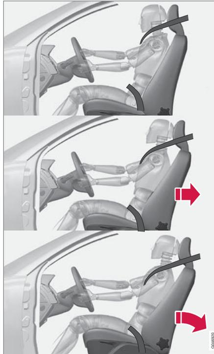
ระบบ WHIPS จะทำงานเมื่อเกิดการชนที่ด้านหลังรถ โดยขึ้นอยู่กับมุมและความเร็วของการชน และลักษณะของรถที่เข้ามาชน
