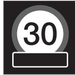
สัญลักษณ์สำหรับป้ายเพิ่มเติมซึ่งอยู่ในรูปของกรอบว่างได้สัญลักษณ์ความเร็วในแผงหน้าปัดแบบรวม<sup>31</sup> หมายความว่า RSI ได้ตรวจพบป้ายเพิ่มเติมซึ่งมีข้อมูลเพิ่มเติมเกี่ยวกับ
