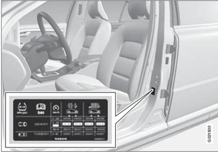
แผ่นป้ายระบุความดันลมยางที่เสาประตูด้านคนขับ (ระหว่างประตูด้านหน้ากับประตูด้านหลัง) จะแสดง ความดันลมยางที่เหมาะสมสำหรับน้ำหนักบรรทุกและความเร็วต่างๆ ซึ่งข้อมูลเหล่านี้จะระบุไว้ในตารางความดันลมยางด้วย
