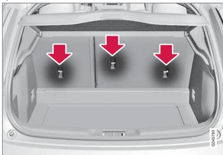
จุดยึดด้านบนจะใช้สำหรับเบาะนั่งสำหรับเด็กแบบหันไปข้างหน้าเป็นหลัก สำหรับเด็กเล็ก วอลโว่ขอแนะนำให้ใช้เบาะนั่งสำหรับเด็กแบบหันหน้าไปข้างหลังให้นานที่สุดเท่าที่จะเป็นไปได้
