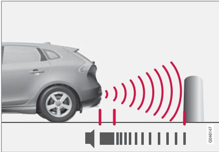
ระยะที่ครอบคลุมถึงทางด้านหลังของรถคือ ประมาณ 1.5 เมตร สัญญาณเสียงสำหรับสิ่งกีดขวางด้านหลังจะมาจากลำโพงตัวใดตัวหนึ่งที่อยู่ด้านหลัง
