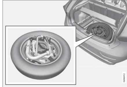
1. ยกขอบด้านหลังของพื้นห้องเก็บสัมภาระขึ้น (หรือสำหรับรุ่นที่ใช้พื้นห้องเก็บสัมภาระแบบหลายส่วนต่อกัน ให้จับที่มีมือจับของพื้นห้องเก็บสัมภาระ แล้วยกส่วนด้านหลังของพื้นขึ้นและเลื่อนไปทางด้านหน้า)
