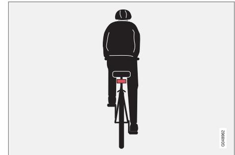
ตัวอย่างที่ดีที่สุดของสิ่งที่ระบบแปลความหมายว่าเป็นคนขี่รถจักรยาน คือ มีเส้นโครงร่างของลำตัวและรถจักรยานอย่าง
