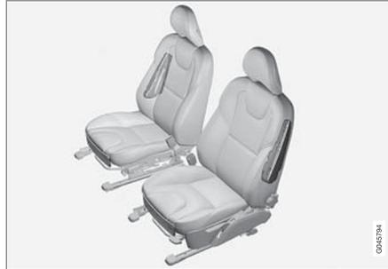
ระบบถุงลมนิรภัย SIPS ประกอบด้วยส่วนประกอบสำคัญสองส่วน คือ ถุงลมนิรภัยด้านข้างและเซ็นเซอร์ต่างๆ ถุงลมนิรภัยด้านข้างจะติดตั้งไว้ในพนักพิงของที่นั่งด้านหน้า
