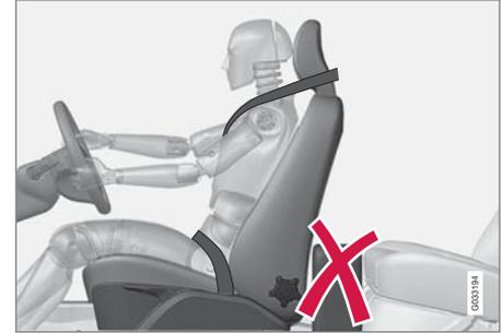
ห้ามวางวัตถุใดๆ ไว้บนพื้นด้านหลังที่นั่งคนขับหรือที่นั่งผู้โดยสารที่อาจกีดขวางไม่ให้ระบบ WHIPS ทำงาน
