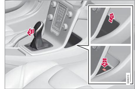
หากไม่สามารถขับขีได้ เช่น เนื่องจากแบตเตอรี่ไฟหมด จะต้องเลื่อนคันเลือกเกียร์ออกจากตำแหน่ง P เพื่อให้สามารถเคลื่อนรถได้
