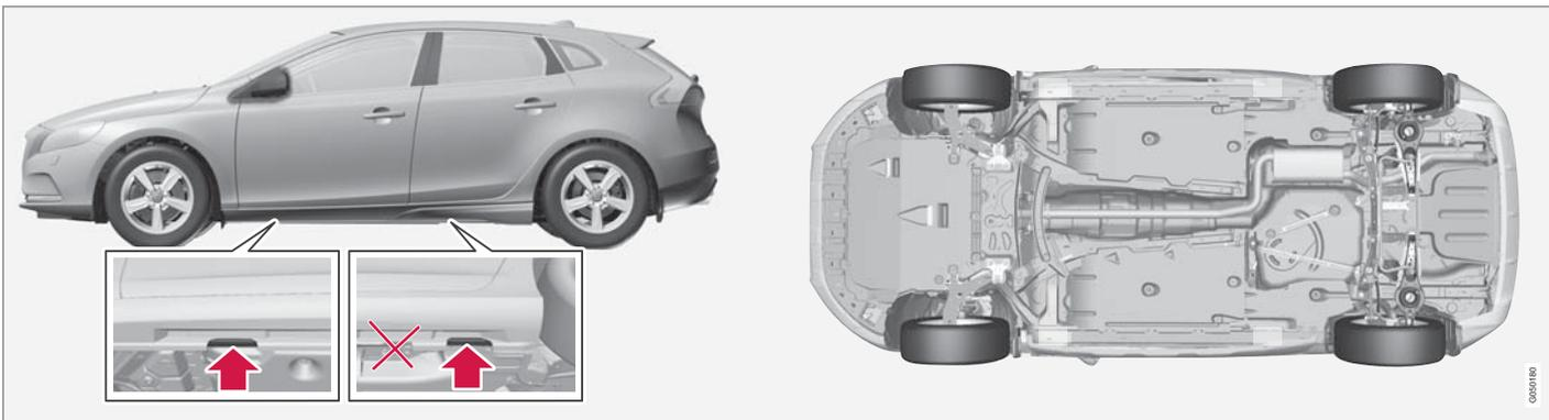
จุดขึ้นแม่แรง (ลูกศร) สำหรับแม่แรงที่ให้มาพร้อมกับรถยนต์ และจุดยกรถ (ที่ทำเครื่องหมายไว้ด้วยสีแดง)
