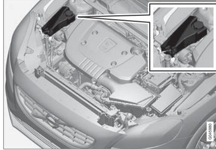
เมื่อเติมน้ำหล่อเย็น ให้ปฏิบัติตามคำแนะนำบนบรรจุภัณฑ์ อย่าเติมน้ำเปล่าเพียงอย่างเดียว ความเสี่ยงในการที่น้ำจะแข็งตัวอาจเพิ่มขึ้น ถ้าความเข้มข้นของน้ำหล่อเย็นมากหรือน้อยเกินไป
