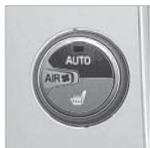
ฟังก์ชันอัตโนมัติจะทำการปรับอุณหภูมิ (น. 165), การปรับอากาศ (น. 166), ความเร็วของพัดลม (น. 164), การหมุนเวียนอากาศภายในรถ (น. 167) และ การกระจายอากาศ (น. 158) โดยอัตโนมัติ
