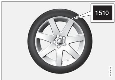
ยางเป็นวัสดุที่เสื่อมสภาพได้ หลังจากสองสามปี ยางจะเริ่มแข็งขึ้นพร้อมกับที่ความสามารถ/คุณสมบัติด้านแรงเสียดทานจะค่อยๆ ลดลง ด้วยเหตุนี้เมื่อเปลี่ยนยาง ควรเลือกยางที่ใหม่ที่สุดเท่าที่จะเป็นไปได้ โดยเฉพาะถ้าเป็นยางสำหรับฤดูหนาวจะเป็นสิ่งสำคัญอย่างยิ่ง ตัวเลขสี่ตัวสุดท้ายหมายถึงสัปดาห์และปีที่ผลิต เครื่องหมาย DOT Department of Transportation ของยางจะระบุไว้ด้วยตัวเลขสี่หลัก ตัวอย่างเช่น 1510 ยางที่แสดงในภาพประกอบได้ผลิตขึ้นในสัปดาห์ที่ 15 ของปี 2010
