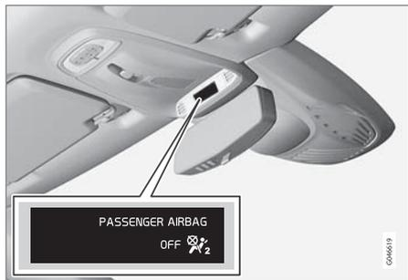
ไฟแสดงจะแสดงว่าถุงลมนิรภัยผู้โดยสารถูกยกเลิกการทำงาน ข้อความและสัญลักษณ์ในคอนโซลหลังคาจะแสดงให้ทราบว่า ถุงลมนิรภัยสำหรับเบาะนั่งผู้โดยสารด้านหน้าถูกยกเลิก (ดูภาพประกอบก่อนหน้านี้)
