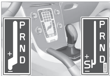
D: automatisch schakelen. +/-: handmatig schakelen. S: Sport-stand 4 .
