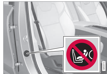
Etichetta sul montante della portiera lato passeggero. L'etichetta è visibile quando si apre la portiera del passeggero.
