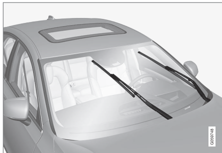
Spazzole tergicristallo in posizione di assistenza.
