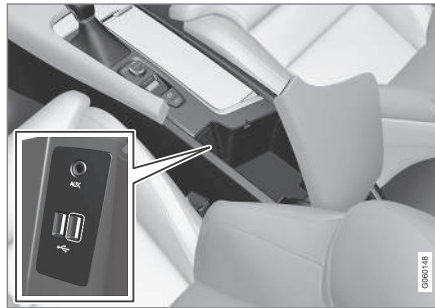
Presa USB nel tunnel.
