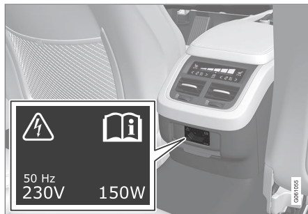
Presse elettrica da 230 V nel tunnel, sedile posteriore.
